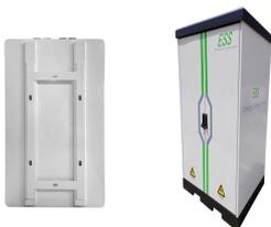
Technische Daten: BYD B-Box LVS 12.0 Nutzkapazität 12,0 kWh Speicher-Technologie LFP Entladeleistung 9,9 kW Notstrom / Off-grid Ja / Ja H x B x T 944 x 650 x 298 mm Gewicht 154 kg Kommunikation CAN / RS485 IP Schutzart IP55 Zertifizierung VDE2510-50 / IEC62619 / CEC / CE / UN38.3 Kompatible Wechselrichter Siehe Liste im Reiter "Download" Die
