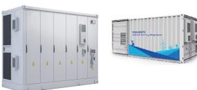
Der eCube eignet sich für die Festinstallation, ist aber dank seiner Installation in einem Standard-Container und der steckbaren Anschlüsse auch für den mobilen Einsatz geeignet. Die Batteriespeicher-Kapazität kann im 10-Fuss-Container zwischen 192 kWh und 1152 kWh konfiguriert werden und im 20-Fuss-Container von 384 kWh bis 2304 kWh
