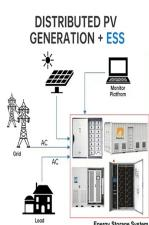
Dans le mode Back-Up, le parc de batteries est maintenu chargé à 100% en permanence par l'électricité solaire et le réseau public. L'onduleur photovoltaïque n'autorise la recharge des batteries que lorsque le réseau public est coupé.
