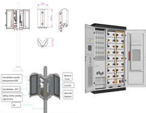
Armario de seguridad fabricado según los requerimientos de la normativa UNE-EN 14470-1 y apto para resguardar y cargar baterías de Litio con resistencia al fuego de 90 minutos. PRODUCTO DISPONIBLE EN STOCK PARA ???
