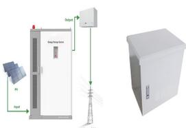
Sistem pembangkit listrik tenaga surya ini tidak terhubung ke jaringan listrik (off grid). Panel surya menangkap cahaya sinar matahari diwaktu siang hari dan disimpan pada baterai setelah melalui
